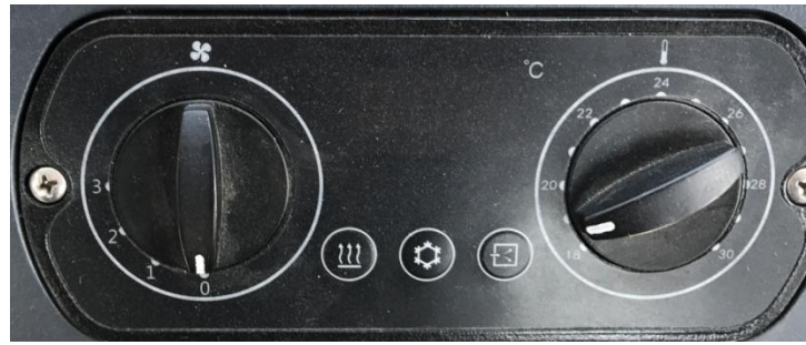
Figura 2-37 Interruptor do ar condicionado
