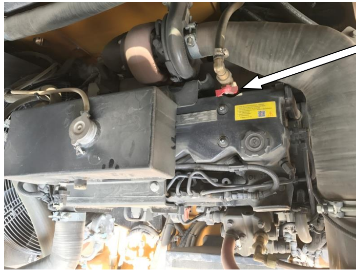
Figura 2-38 Diagrama esquemático da posição da válvula de água quente
