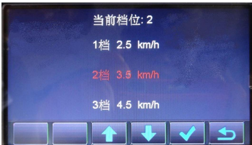
No interface de selecção do menu de funções, utilize os botões ↑ ↓ para seleccionar "Ajuste da marcha do aspersor", e confirme a selecção com o botão √ para entrar no interface de definição da marcha do aspersor (figura 2-10), existem sete opções para o modo de controlo de intervalo intermitente do aspersor,
