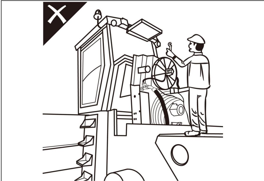
2. Toda a manutenção do sistema de ar condicionado (incluindo o abastecimento de refrigerante) deve ser realizada numa oficina com equipamento especial.
