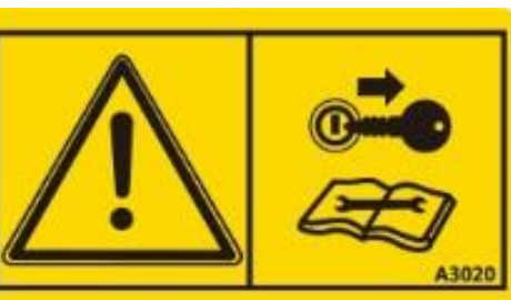
Figura 1-8 Antes da manutenção e reparo, desligue o motor e remova a chave
