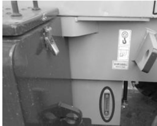
Figura 3- 3 Medidor de nível de combustível do tanque de combustível
