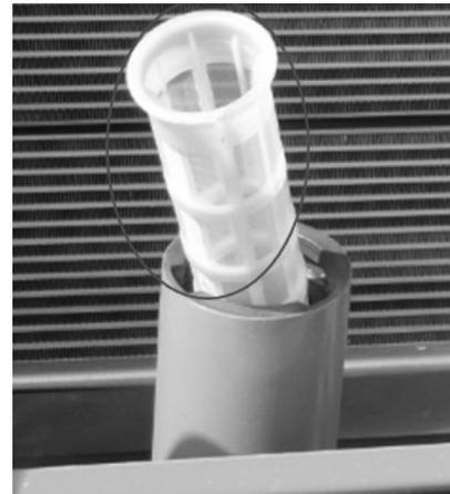
Figura 3- Filtro de abastecimento do tanque de combustível
