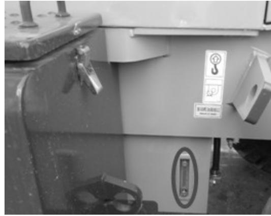
Figura 3- Indicador do nível do tanque de combustível
