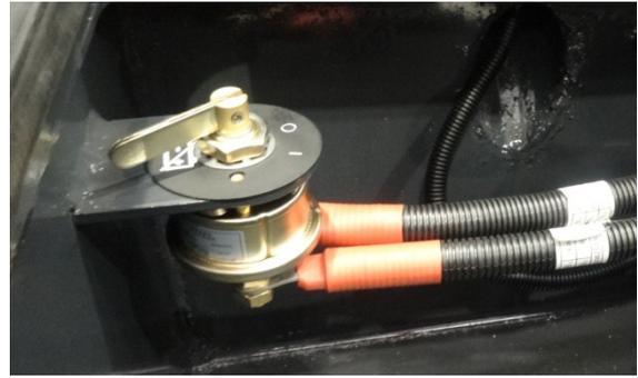
**Figura 2-15 Interruptor de Desconexão da Bateria**
