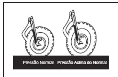
pneus é aumentada devido ao calor produzido. Esta é uma situação normal, portanto, não tente reduzir a pressão. Apenas desacelere ou pare a máquina para resfriar os pneus. No entanto, lembre-se de que a condução prolongada da máquina em alta velocidade pode causar o superaquecimento dos pneus e sua eventual explosão.
