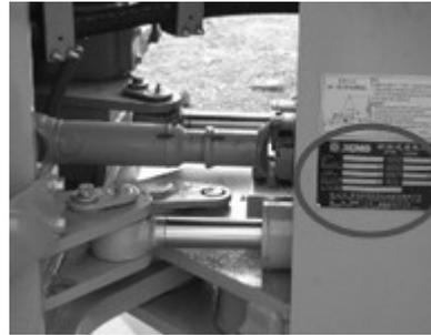
Figura 4- Localização da placa de identificação da máquina
